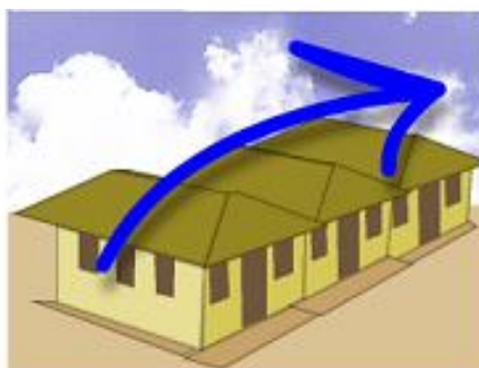
Figura N° 11. En un clima frío o templado Las aulas se ubicarán juntas para protegerse de los vientos, manteniendo así una temperatura interior superior a la del medio ambiente.
