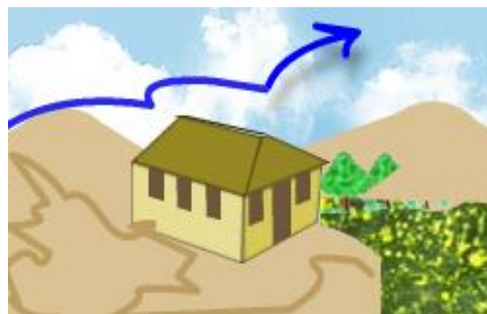
Figura N° 8. En climas fríos con bajas de humedad La edificación del local educativo se protegerá en la parte baja del terreno de las temperaturas bajas y de los vientos.
