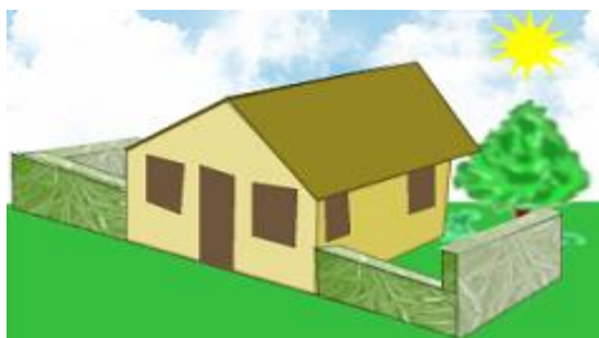
Figura N° 5. En climas templados o fríos En donde sea necesario aprovechar la radiación solar para incrementar la temperatura interior en el día y almacenarla para ser utilizada durante la noche.
