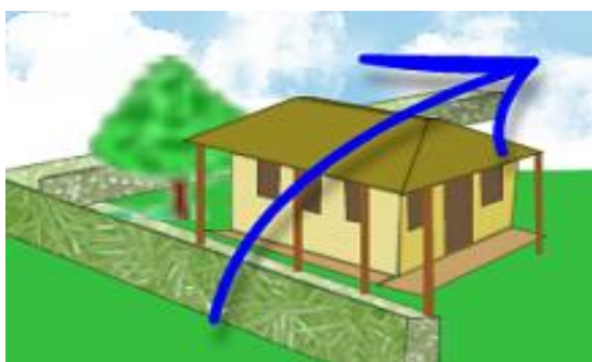
Figura N° 12. En climas cálidos con vientos fuertes Las aulas se ubicarán separadas pero protegidas con vegetación, de esta forma se controlan los vientos y se permite liberar el exceso de humedad.
