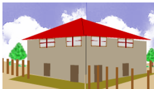
Figura N° 4. En climas muy fríos y secos Una planta cerrada y compacta nos brinda protección contra la acción del viento, evitando las pérdidas de calor interno en las edificaciones.
