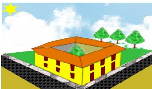
Figura N° 3. En climas templados con escasa humedad Una planta cerrada con patio aísla de tal forma que permite equilibrar las diferencias de temperatura entre el día y la noche.
