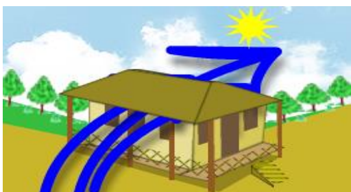
Figura N° 1. En climas muy cálidos y húmedos Al desarrollar una planta lineal y abierta, se está aprovechando al máximo la acción de los vientos y se refrescaría la temperatura interior alta, se liberaría el exceso de humedad ambiental.
