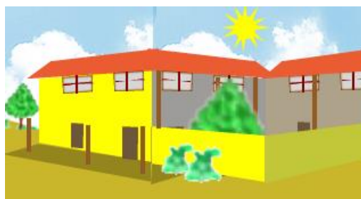
Figura N° 2. En clima cálido-húmedo En una planta abierta con patio mediante la ventilación se libera la humedad, pero conserva cierto aislamiento para equilibrar diferencias de temperatura entre el día y la noche.
